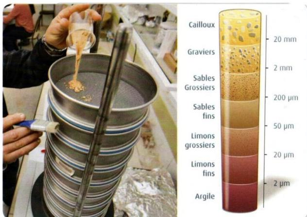
**2** **Clef de détermination des produits issus de l'érosion.** La taille est un critère de détermination des particules issues de l'érosion. La répartition des produits d'érosion selon leur taille définit leur granulométrie.
